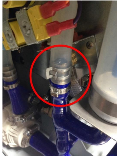
Raccordez le tuyau du condensat
